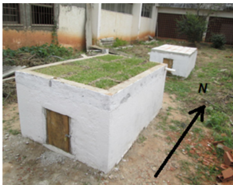
Figura 1 - Modelo reduzido experimental: em primeiro plano o modelo coberto com telhado verde usado para comparação com o programa EnergyPlus .
